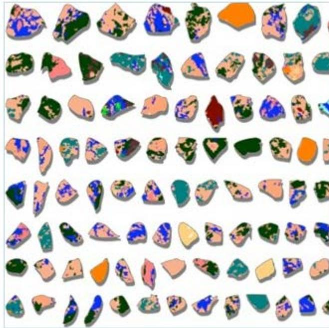
**Figure 9.** Exemple d'image produite par le QEMSCAN (source : site internet d'Actlab).
