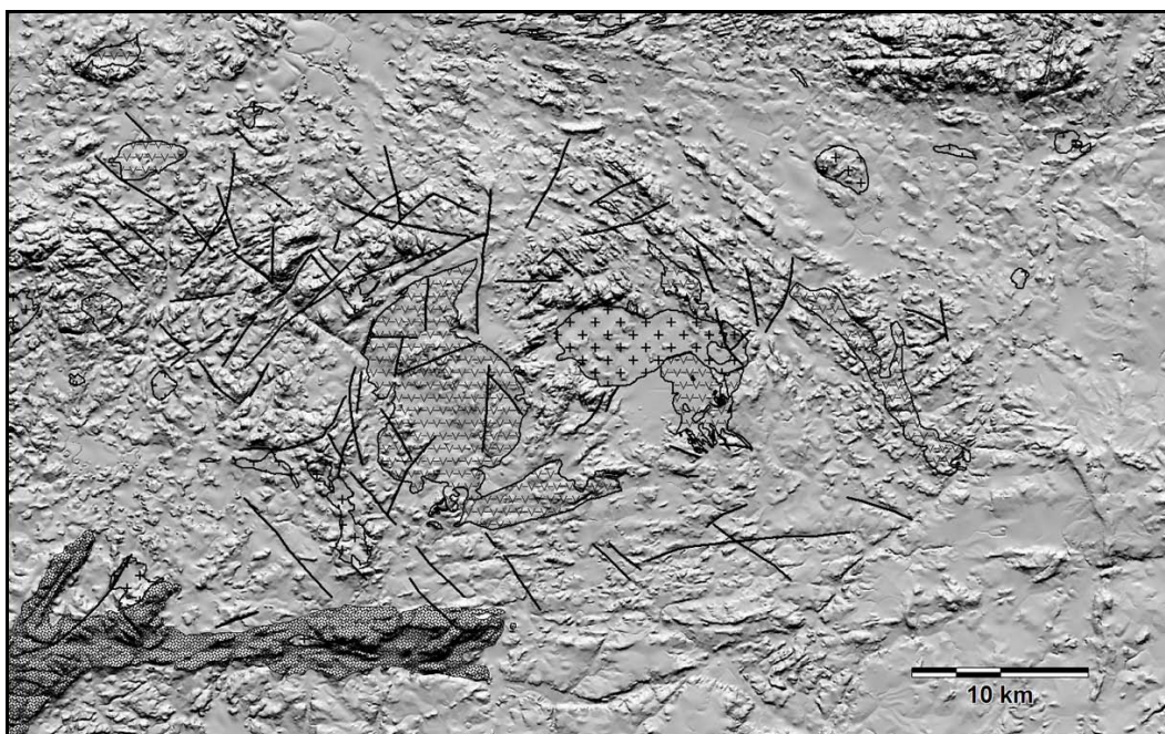
Figure 22 : Les 81 prolongements de failles connues déduits à partir d'un modèle numérique d'élévation de terrain de la compagnie Xstrata Copper. Roches protérozoïques (gris foncé). Retour au texte
