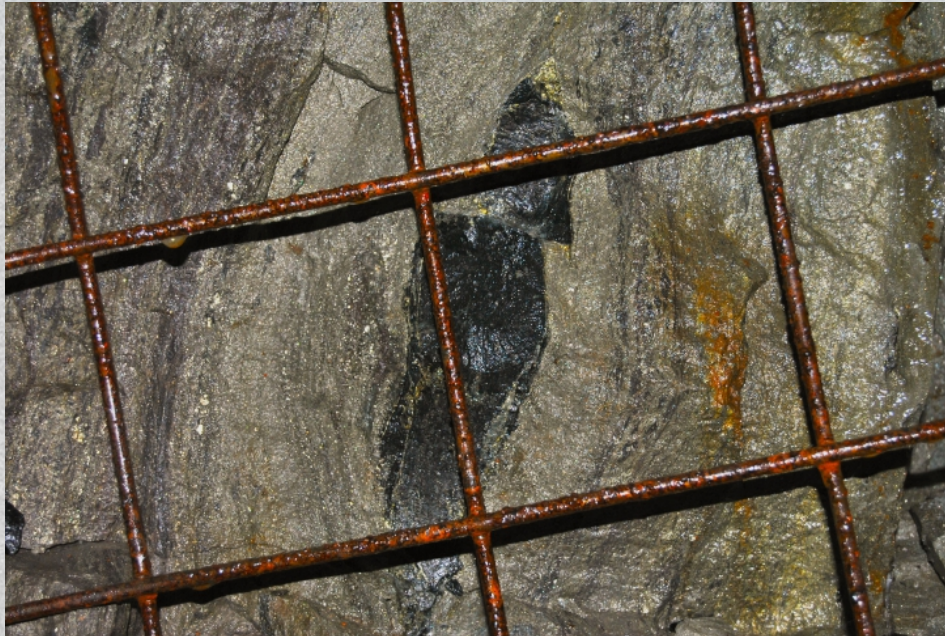
Chalcopyrite en ombre de pression dans la direction du rubanement
