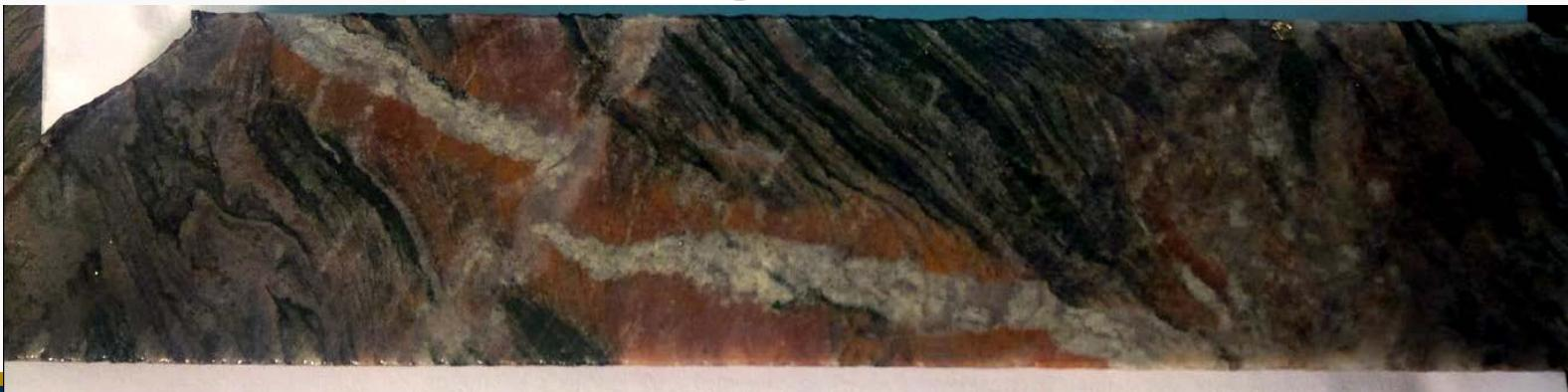
Couleur orangée (hematite) typique de plusieurs zones minéralisées; sulfures disséminés, pas de grosses veines de quartz (note: la géochimie nous confirme que ce n'est PAS de l'alteration potassique)
