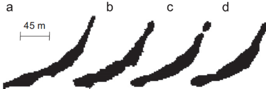
Figure 16 : Simulations d’une forme de dépôt. Vue en coupe : a) de l’image d’entraînement, b) le résultat filtré selon le maximum, c) filtré selon la médiane et d) filtré selon le minimum (tiré de Goodfellow et al., 2012).
