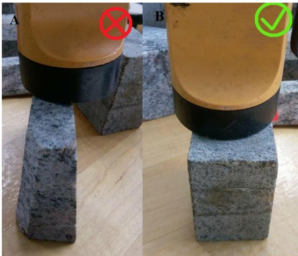
Figure 22. À gauche, mauvaise surface pour la prise de mesure, à droite surface plane idéale pour le protocole de mesures.
